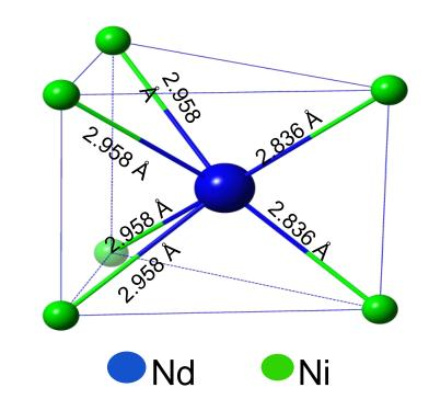
$$\begin{split} H &= B_2^0 \hat{O}_2^0 + B_2^2 \hat{O}_2^2 + B_4^0 \hat{O}_4^0 + B_4^2 \hat{O}_4^2 + B_4^4 \hat{O}_4^4 + \\ & B_6^0 \hat{O}_6^0 + B_6^2 \hat{O}_6^2 + B_6^4 \hat{O}_6^4 + B_6^6 \hat{O}_6^6 \end{split}$$
