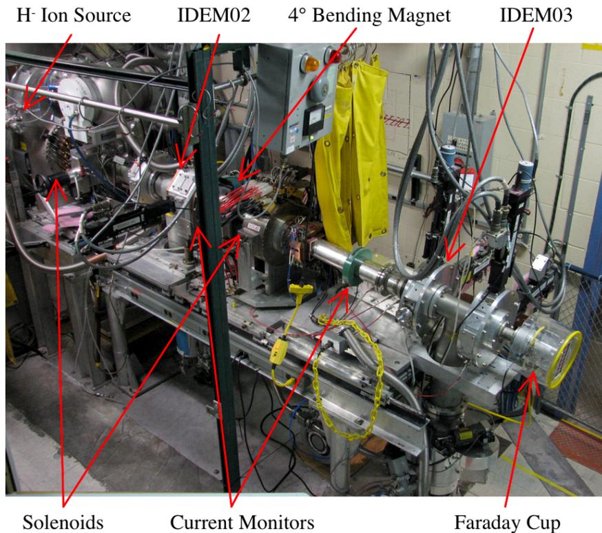
LANSCE H<sup>-</sup> Ion Source Test Stand
